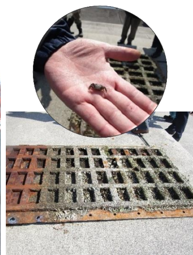
▲ 撤去した鋼製パネルに生物が 付着している様子が観察できた
